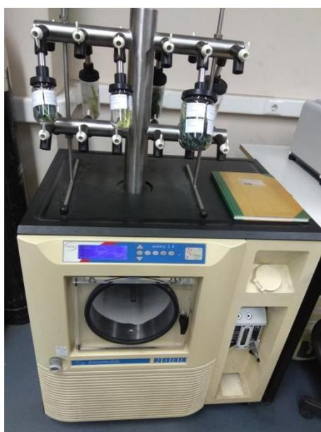
**Εικόνα 3.6: Λυοφιλίωση των δειγμάτων**
