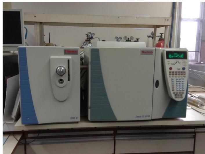
**Εικόνα 3.22: Όργανο αέριας χρωματογραφίας – φασματομετρίας μάζας ThermoScientificDSQII**
