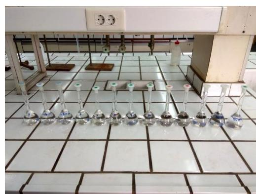
Εικόνα 3.12: Τα προς μέτρηση διαλύματα των δειγμάτων για HG-AAS
