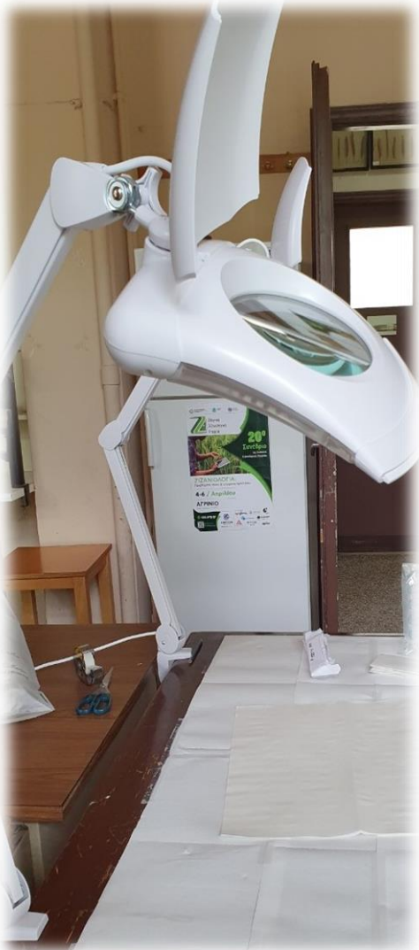
Εικόνα 14: Μεγεθυντικός φακός για διαχωρισμό των σπόρων
