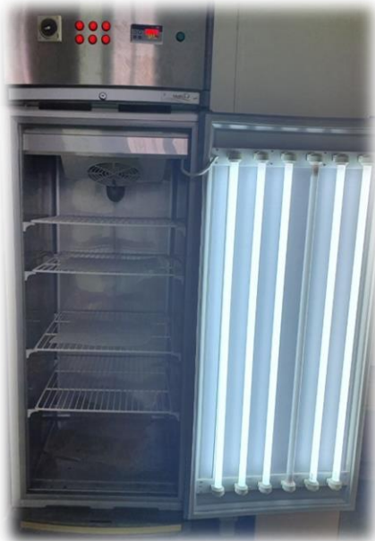
Εικόνα 19: Θάλαμος με δυνατότητα ρύθμισης της θερμοκρασίας
