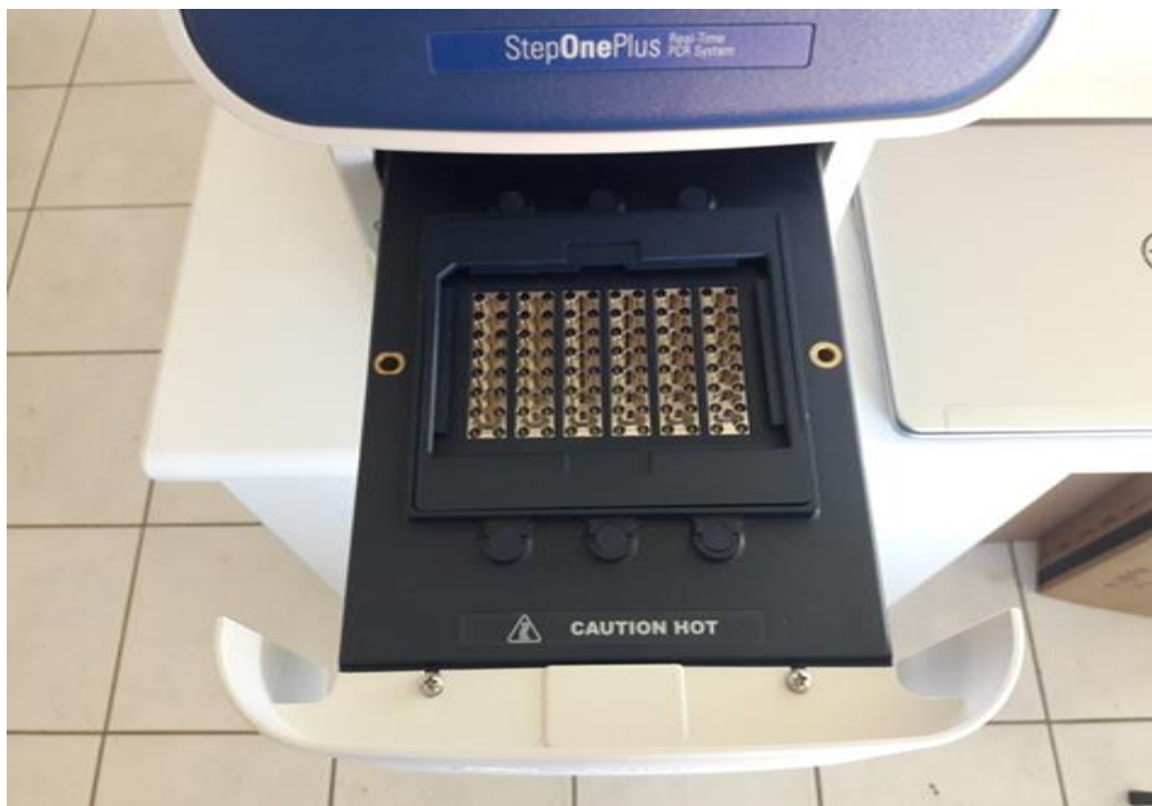
Εικόνα 9: Α: Συσκευή StepOnePlus, Real – Time PCR της AB – Applied Biosystems με Β: θήκη υποδοχής των strips για τα προς πολλαπλασιασμό δείγματα cDNAs.
