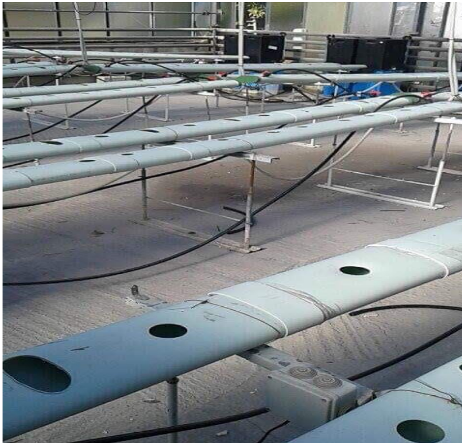
Εικόνα : Ειδικά κανάλια P.V.C για καλλιέργεια N.F.T
