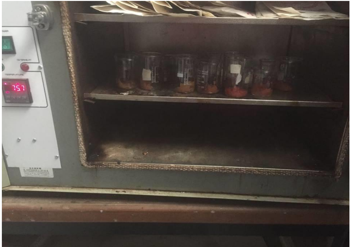
Εικόνα : Φούρνος διαμορφωμένος σε θερμοκρασία 80°C.
