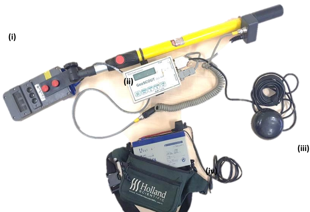
Εικόνα 57: Crop Circle ACS-470 (i) Canopy Sensor (ii) GeoSCOUTGLS 400 datalogger (iii) GPS (iv) Μπαταρία
