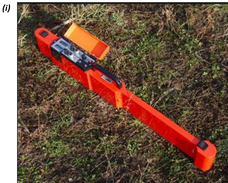
Εικόνα 2: Συστήματα μέτρησης ηλεκτρικής αγωγιμότητας χωρίς επαφή (i) EM38 και (ii) GEM-2
