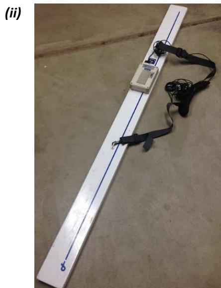
Εικόνα 2: Συστήματα μέτρησης ηλεκτρικής αγωγιμότητας χωρίς επαφή (i) EM38 και (ii) GEM-2
