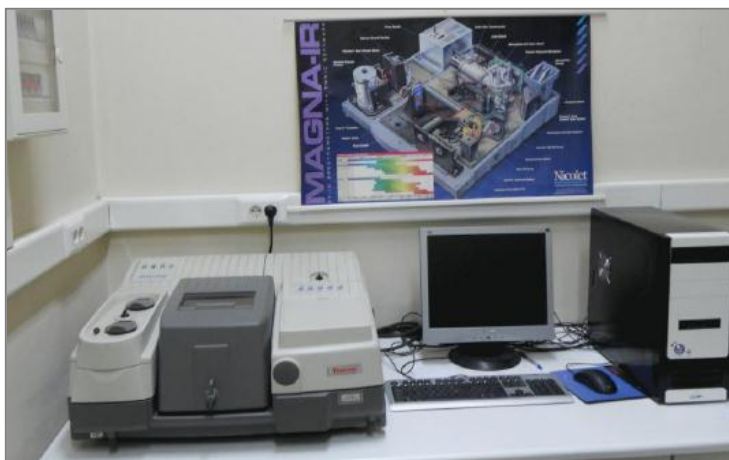
Εικόνα 24: Το φασματοφωτόμετρο FTIR Thermo Nicolet 7600 που χρησιμοποιήθηκε για τη φασματοσκοπική μελέτη.
