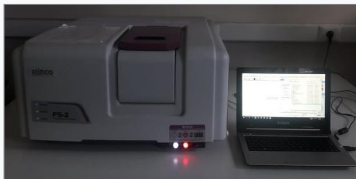
Εικόνα 28: Το φασματοφωτόμετρο φθορισμού που χρησιμοποιήθηκε για τη φασματοσκοπική μελέτη
