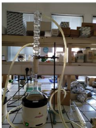
Εικόνα 20: Συσκευή Soxhlet που χρησιμοποιήθηκε
