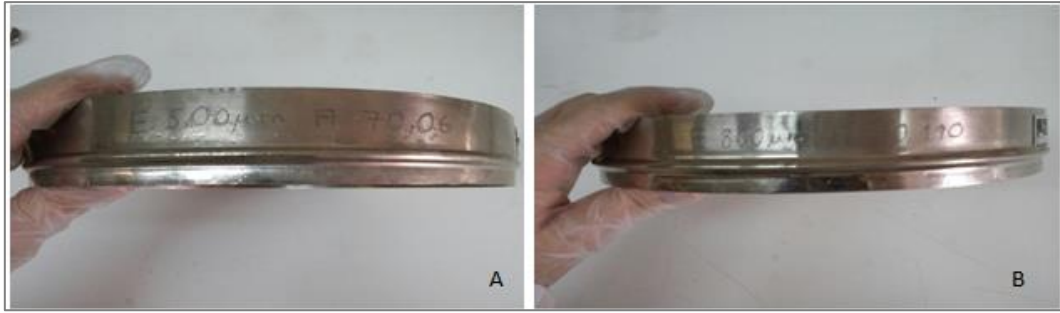
Εικόνα 16: Κόσκινα μεγέθους 500μm και 800μm
