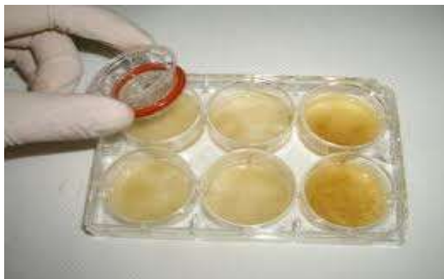
Εικόνα 4.7. Δείγμα πέψης σε πηγάδια από δοχεία 6 θέσεων (well plate) με το αντίστοιχο ένθετο που φέρει μεμβράνη στο ένα του άκρο.
