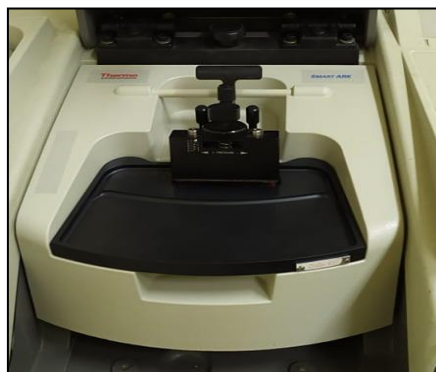
Εικόνα Β.8. Υποδοχή με κρύσταλλο ZnSe που χρησιμοποιήθηκε στην τεχνική ATR.
