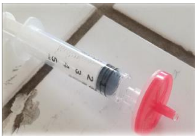
Εικόνα Β.6. Καθαρισμός υδρομεθανολικών εκχυλισμάτων και κλασματοποίηση (πολικών και μη συστατικά) με φίλτρα HPLC Chromafil Xtra CA-45/25.
