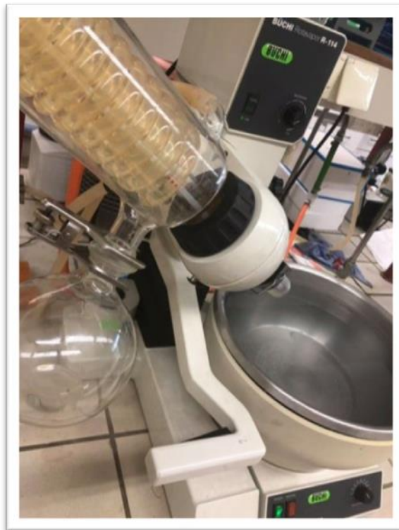
Εικόνα 2.6: Περιστροφικός εξατμιστήρας τύπου Flash Evaporator- Rotavapor R -114
