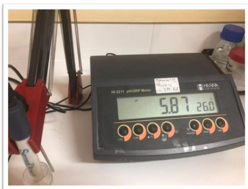
Εικόνα 2.3: pH-μετρο τύπου Hanna instruments HI 2211 PH/ORP Meter
