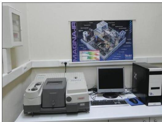
**Εικόνα 24:** Το φασματοφωτόμετρο FT-IR που χρησιμοποιήθηκε στις αναλύσεις.
