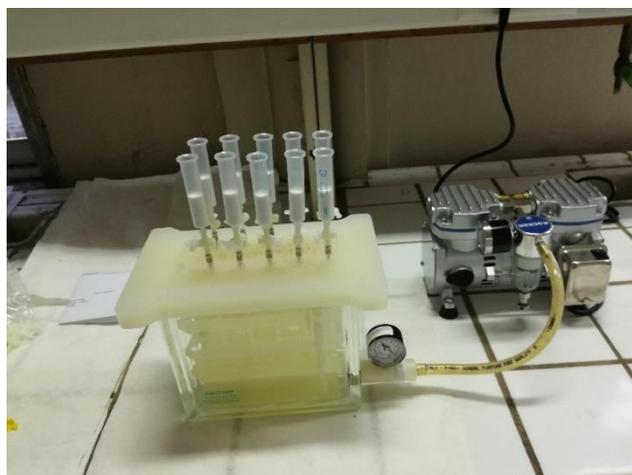
Εικόνα 18: Εκχύλιση των φαινολικών συστατικών του μελιού κουμαριάς με SPE.
