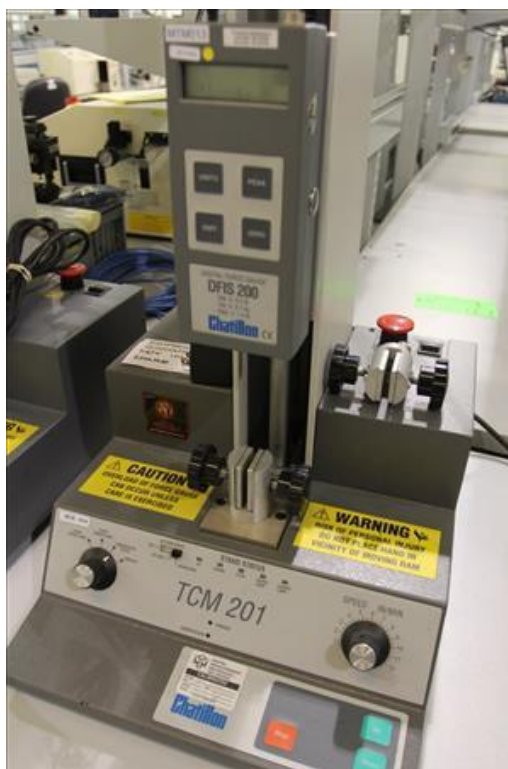
Εικόνα 19: Επιτραπέζιο πενετρόμετρο Chatillon DFIS 10 προσαρμοσμένο στη βάση Chatillon TCM 201.
