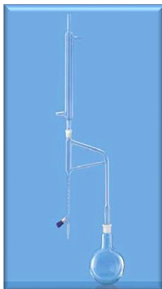
Εικόνα 2.4. Συσκευή υδρο-απόσταξης τύπου Clevenger
