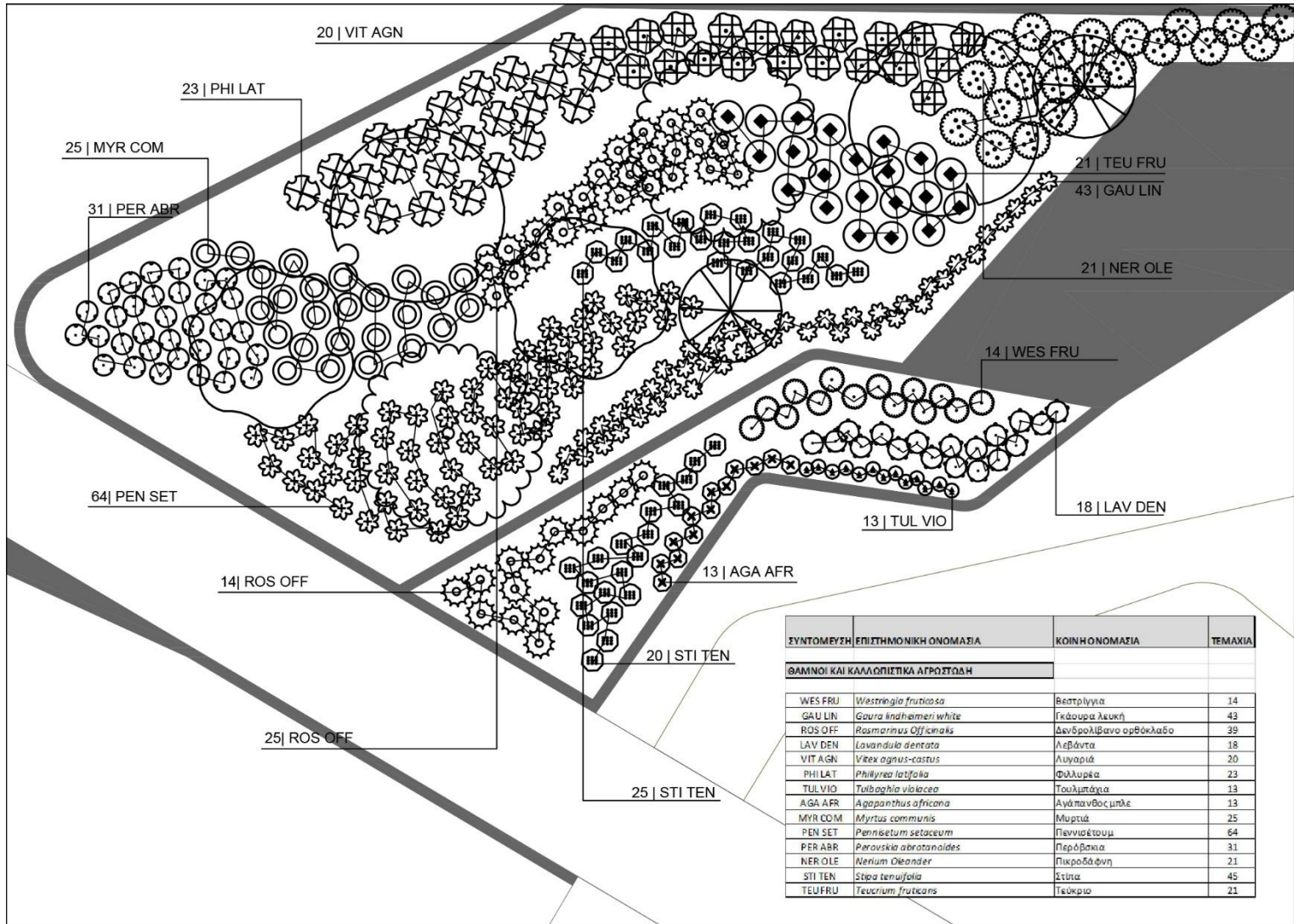
Εικόνα 74: Φυτοτεχνικό σχέδιο-Θάμνων. Ιδία επεξεργασία. Κλίμακα 1:200
