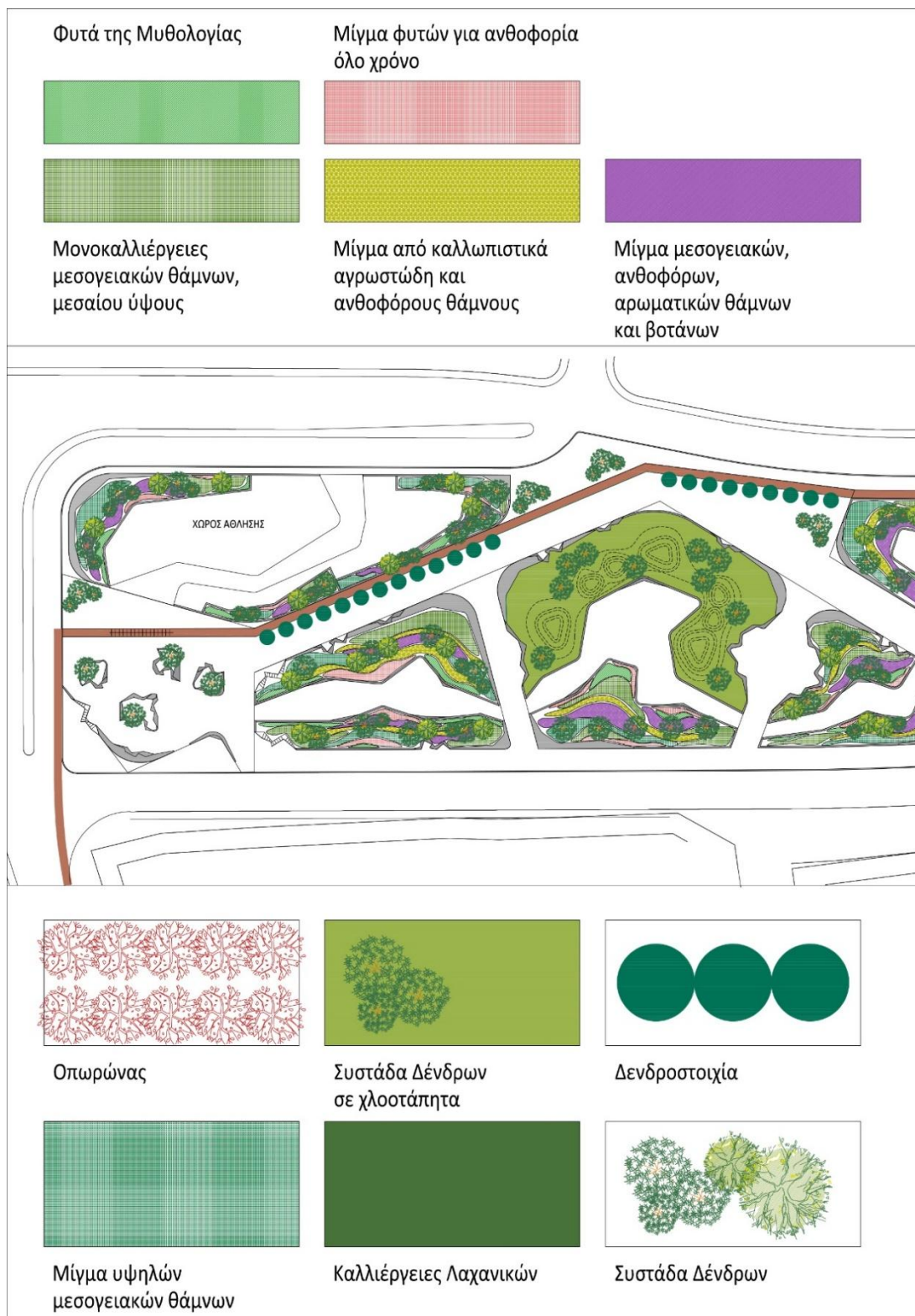
Εικόνα 62: Φυτοτεχνικό σχέδιο περιοχών Χώρου Άθλησης και Λόφων με χλοοτάπητα και συστάδες δένδρων. Ιδία επεξεργασία.Κλίμακα 1:1000.
