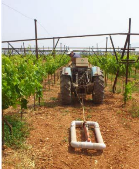
Εικόνα 17 Χαρτογράφηση ηλεκτρικής αγωγιμότητας με την χρήση του αισθητήρα EM38.
