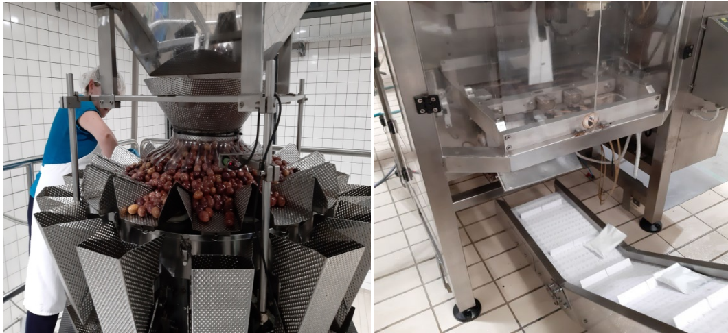
Εικόνα 6 – 7. Μηχάνημα τροφοδοσίας της ελιάς (αριστερά) και μηχάνημα τελικής συσκευασίας σε πολυστρωματικούς περιέκτες (δεξιά).
