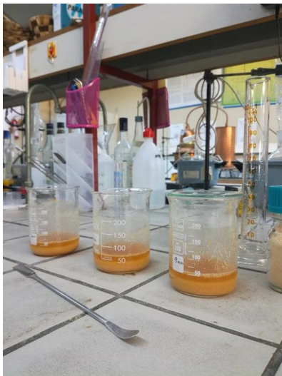
Εικόνα 9. Μίγμα διαλύτη με σκόνη μεσοκαρπίου
