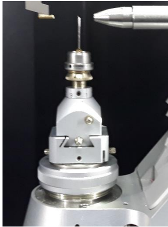
Εικόνα 21. Γωνιομετρική κεφαλή στήριξης του τριχοειδούς σωλήνα που περιέχει το δείγμα.
