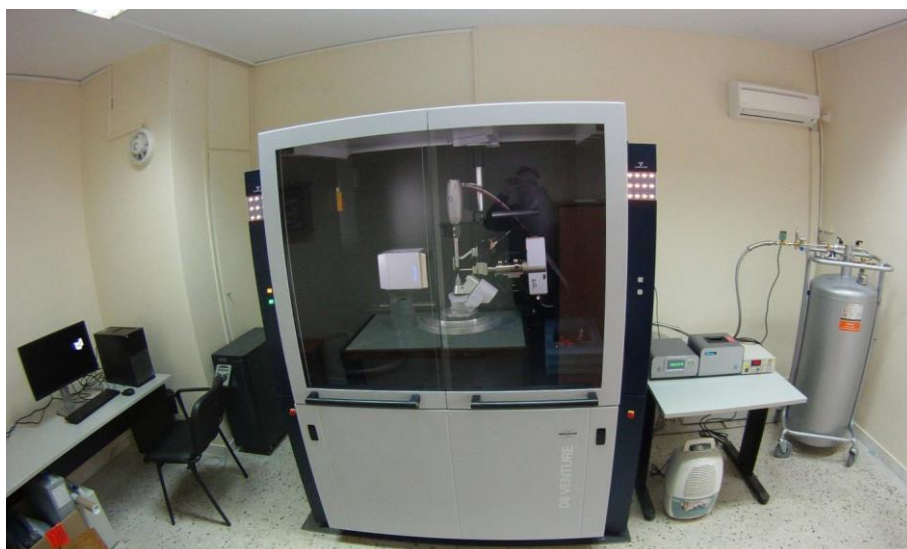
Εικόνα 19. Περιθλασίμετρο ακτίνων-X D8 Venture της Bruker στο Εργαστήριο Φυσικής του ΓΠΑ
