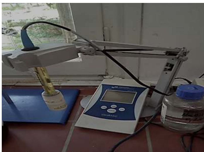
Εικόνα: Όργανο μέτρησης pH
