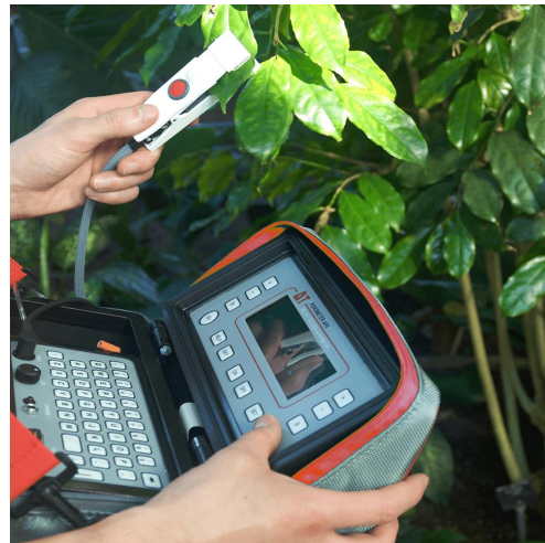
Εικόνα 19. Απεικόνιση συσκευής WET Kit δεξιά και AP4 Porometer αριστερά (Δ14).
