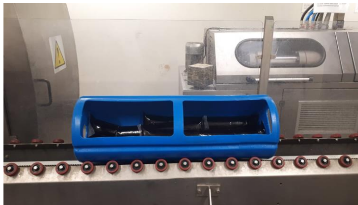
Εικόνα 12: Τα δείγματα οίνου συσκευασμένα σε περιέκτες πολυαιθυλενίου και μέσα στο δοχείο για το όργανο εφαρμογής ΗΗΡ
