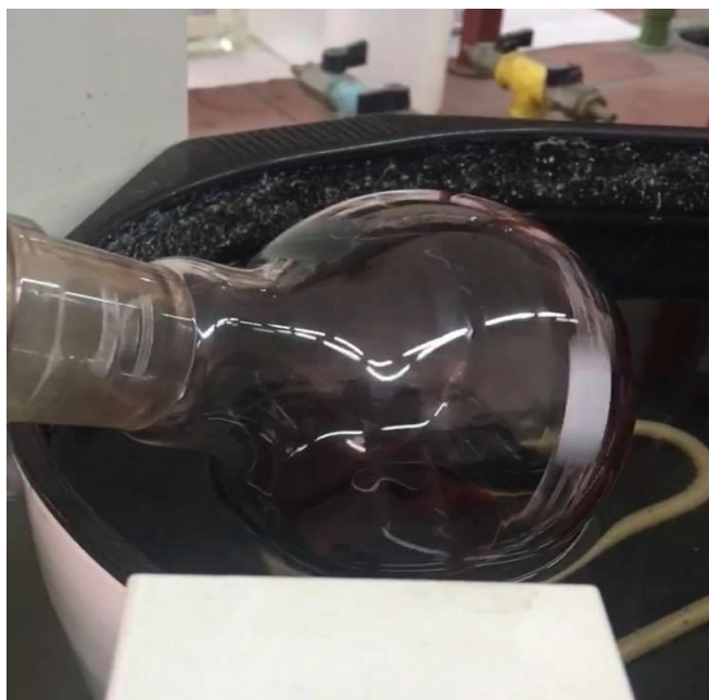
Εικόνα 13: Εξάτμιση οίνου υπό κενό (Rotary Evaporation)
