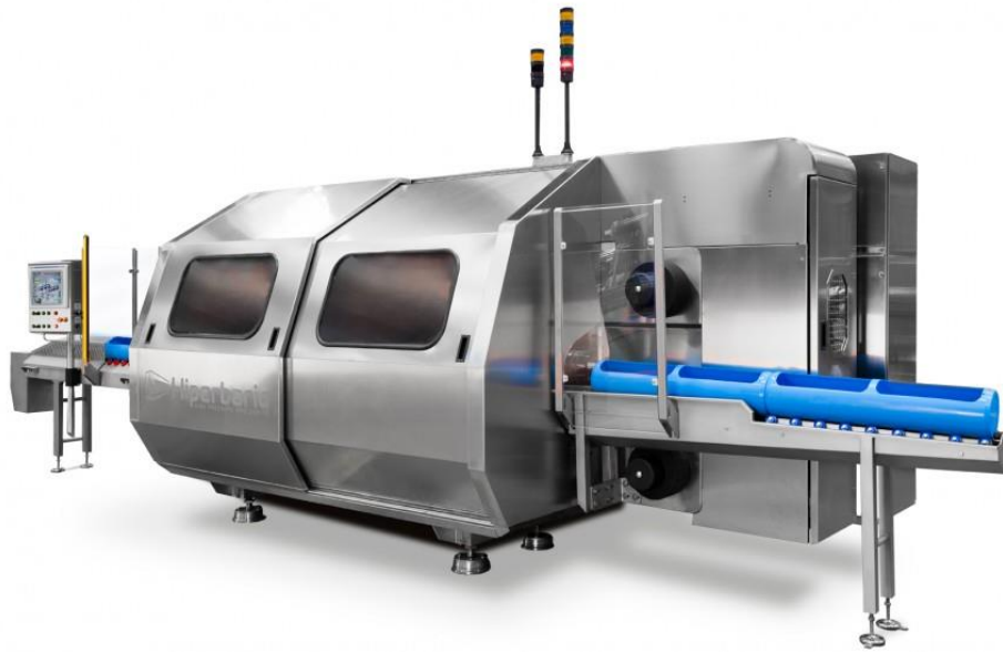
Εικόνα 9: Όργανο εφαρμογής της Υψηλής Υδροστατικής Πίεσης.
