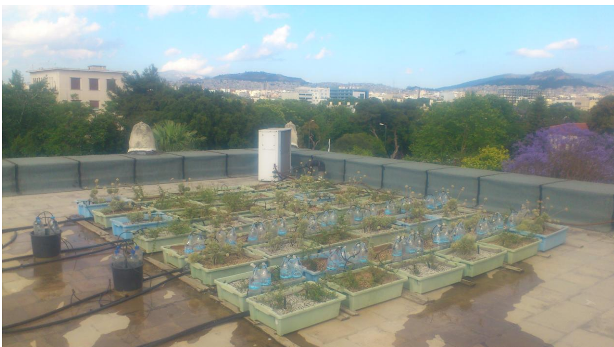
Εικόνα 30: Έλεγχος παροχής σταλακτών με διαφανή βαθμονομημένα δοχεία.
