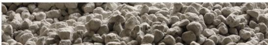
Εικόνα 29: Ελαφρόπετρα προερχόμενη από την εταιρεία LAVA mining & Quarrying Co
