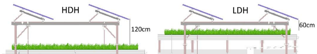
Εικόνα 11: Φωτοβολταϊκές εγκαταστάσεις πάνω από εκτατικό φυτοδώμα. Η πρώτη διάταξη είναι αποδοτικότερη.
