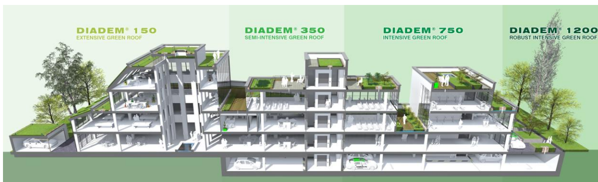
Εικόνα 5: Σύγκριση των διαφορετικών τύπων φυτοδωμάτων
