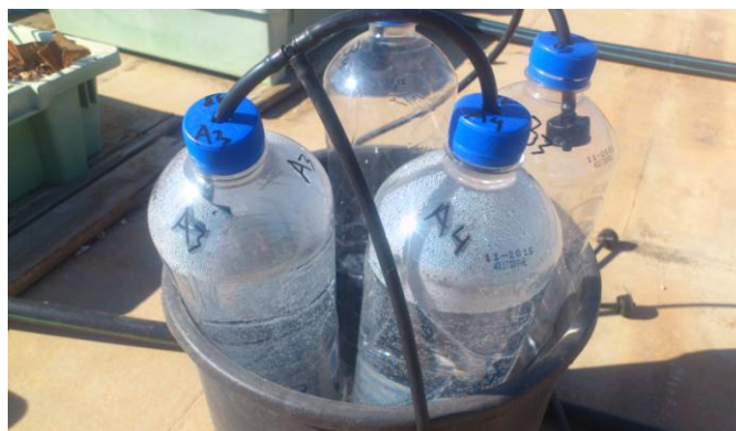
Εικόνα 40: Αυτοσχέδια εγκατάσταση ελέγχου δικτύου άρδευσης
