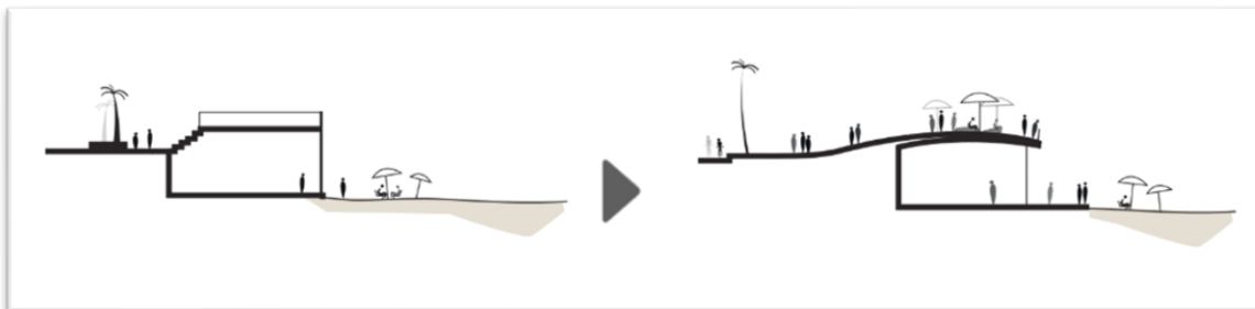
Εικόνα 3. Τομή της νέας διαμόρφωσης των σκεπών σε βεράντες, Τελ-Αβίβ (πηγή: Mayslits Kassif Architects)
