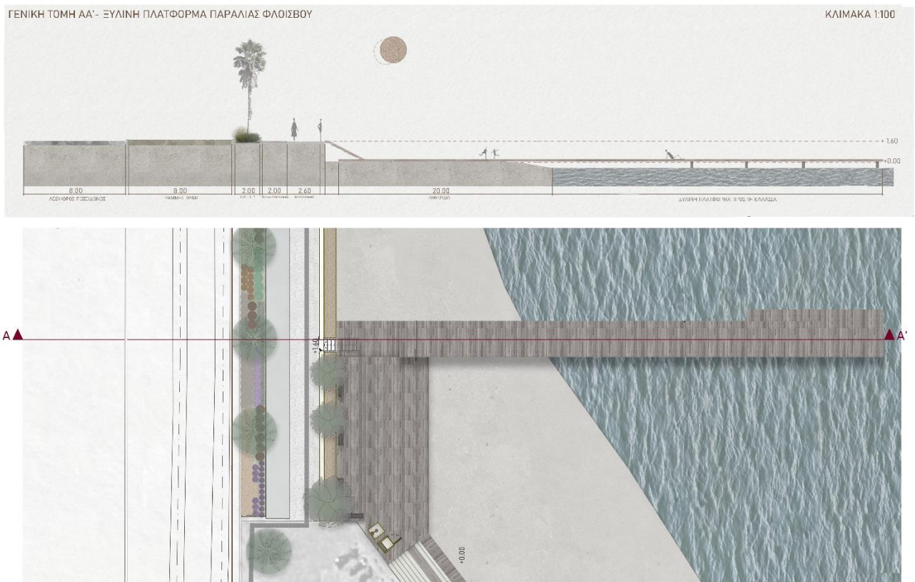
Εικόνα 120. Γενική τομή παραλίας Φλοίσβου με την ξύλινη εξέδρα
