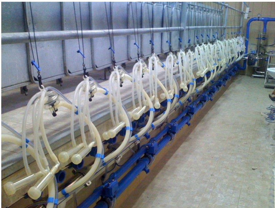
Εικόνα 10. Ευθύγραμμοαρμεκτικό συγκρότημα αιγοπροβάτων ταχείας εξόδου
