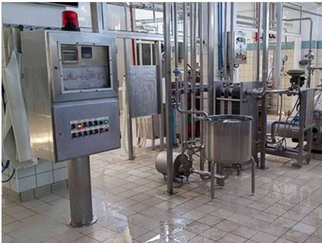
Εικόνα 7.ΓραμμηπαστερίωσηςγαλακτοςHTSTστην «Γαλακτοκομική Κρήτης»
