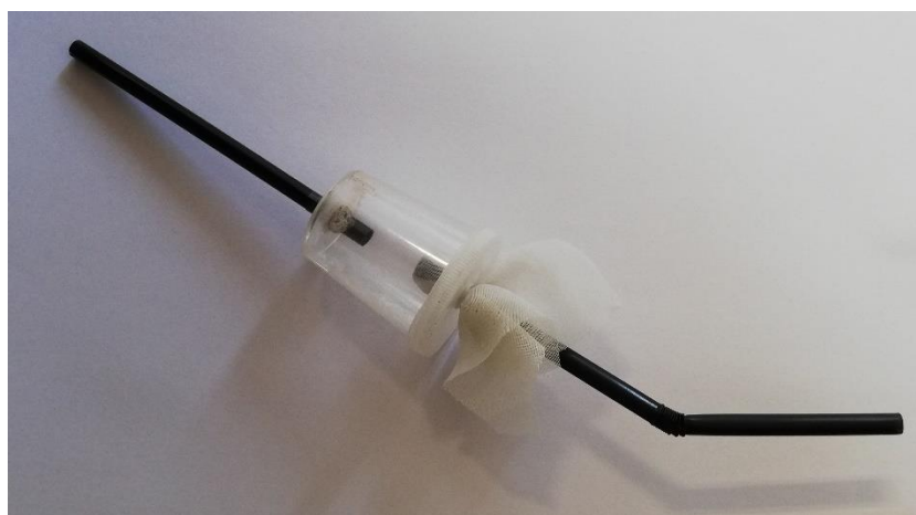
Εικόνα 11. Αυτοσχέδιος αναρροφητήρας συλλογής νυμφών N. tenuis .
