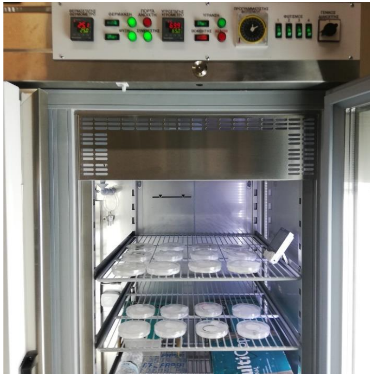
Εικόνα 15. Τοποθέτηση των τρυβλίων στο θάλαμο σταθερών συνθηκών για διεξαγωγή πειραμάτων.
