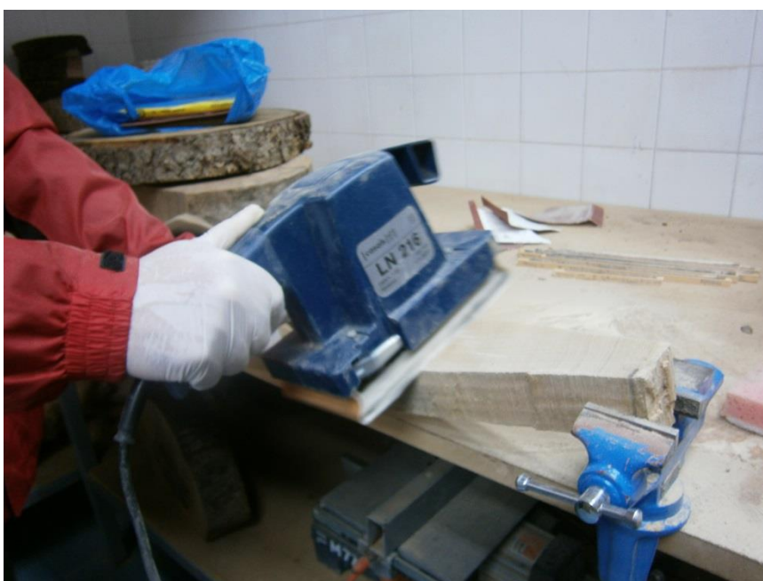
Εικ.4.2.4. Λείανση τμήματος εγκάρσιας τομής με παλμικό τριβείο (φωτ. Παπαδόπουλος Α.)
