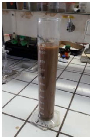
Εικόνα 10: Ο ογκομετρικός κύλινδρος από 2 ώρες απόλυτης ηρύθρευσης του Βουγιούκου
