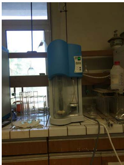
Εικόνα 13: Η συσκευή απόσταξης "Bucchi"
