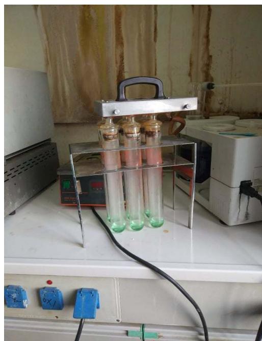
Εικόνα 14: Οι φιάλες "Kjeldahl"
