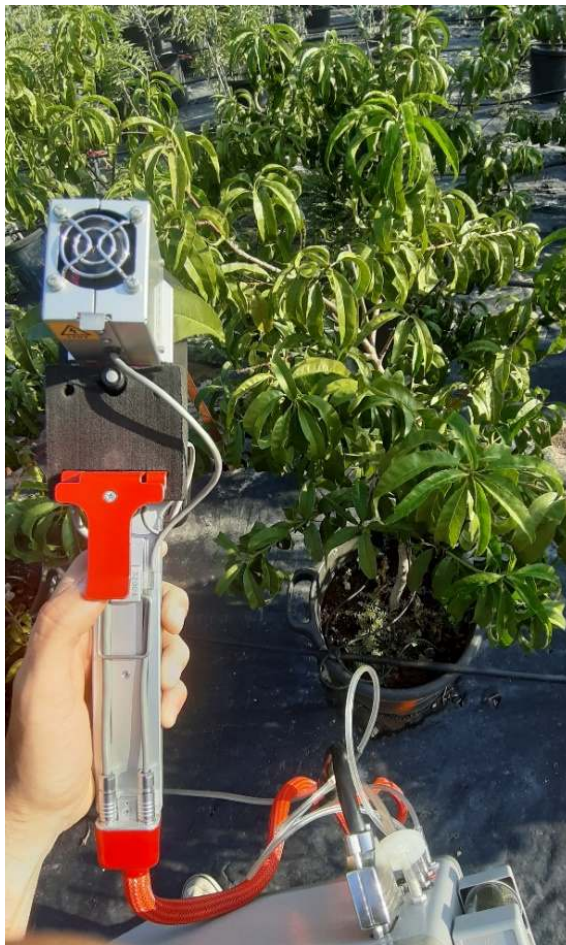
Εικόνα 9: Μέτρηση φωτοσύνθεσης με το φορητό όργανο ADC LCipro+ στο δενδροκομείο του Γ.Π.Α.
