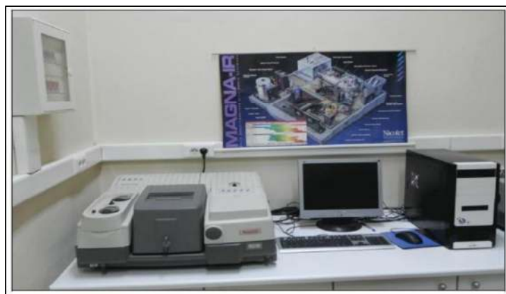
Εικόνα 9: Το φασματοφωτόμετρο FT-IR Thermo Nicolet 7600 που χρησιμοποιήθηκε για τη φασματοσκοπική μελέτη.
