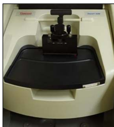
Εικόνα 10: Σύστημα ATR του φασματοφωτομέτρου FT-IR Thermo Nicolet 7600
