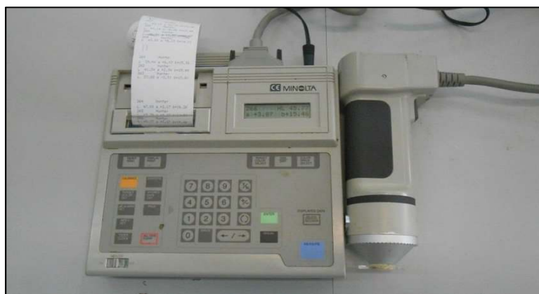
Εικόνα 17. Χρωματόμετρο Minolta CR-300
