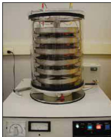
Εικόνα 19. Μηχάνημα λυοφιλίωσης Thermosavant
