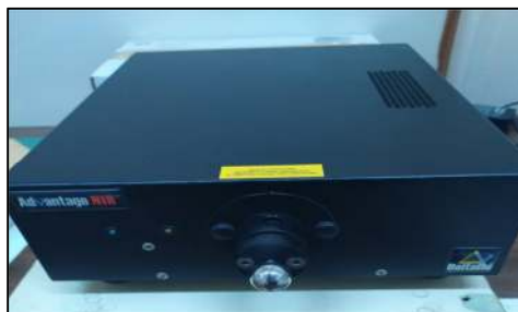
Εικόνα 11: Το φασματοφωτόμετρο Raman που χρησιμοποιήθηκε στη φασματοσκοπική μελέτη
