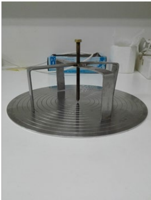
Εικόνα 1. Δίσκος και κοχλίας με τρίποδα, που χρησιμοποιήθηκαν για τη μέτρηση του ύψους της παχύρρευστης αλβουμίνης
