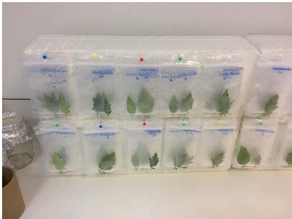
Εικόνα 2.11. Υπολογισμός της Σχετικής Περιεκτικότητας σε Νερό - Relative Water Content (%). Τα φύλλα παρέμειναν 24 ώρες μέχρι να κορεστούν με το διάλυμα.
