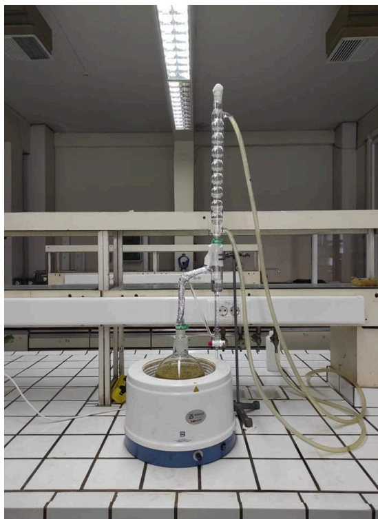
Εικόνα 2.3. Συσκευή απόσταξης Clevenger
