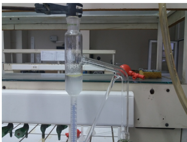
Εικόνα 2.4. Διαχωρισμός δύο φάσεων (πάνω το έλαιο και κάτω το υδρόλυμα)
