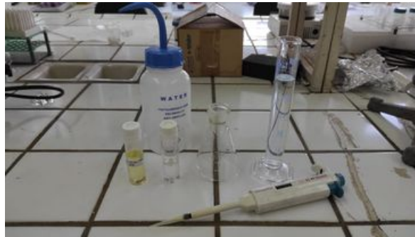
Εικόνα 2.8. Απιονισμένο νερό, έλαιο και DMSO ως γαλακτωματοποιητής για την παρασκευή διαλύματος
