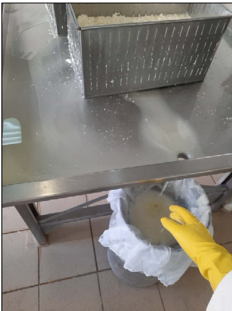
Εικόνα 23. Συλλογή του ορού του γάλακτος (πρωτογενές τυρόγαλα) κατά τη στράγγιση του τυροπήγματος σε ειδικά καλούπια παρασκευής φέτας (Εργαστήριο Γαλακτοκομίας, Γ.Π.Α.).
