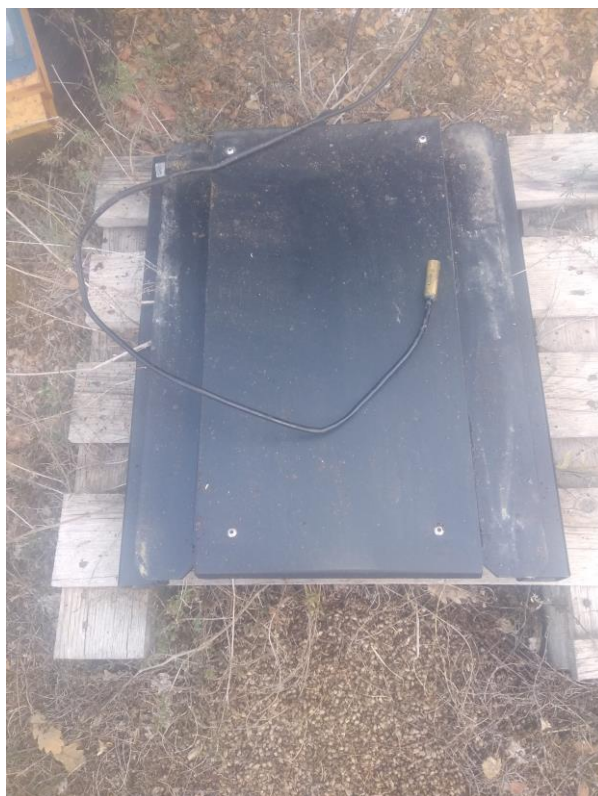
Εικόνα 3.2. Ζυγαριά για τη ζύγιση του βάρους και αισθητήρες για τη λήψη των θερμοϋγρομετρικών παραμέτρων της κυψέλης.
