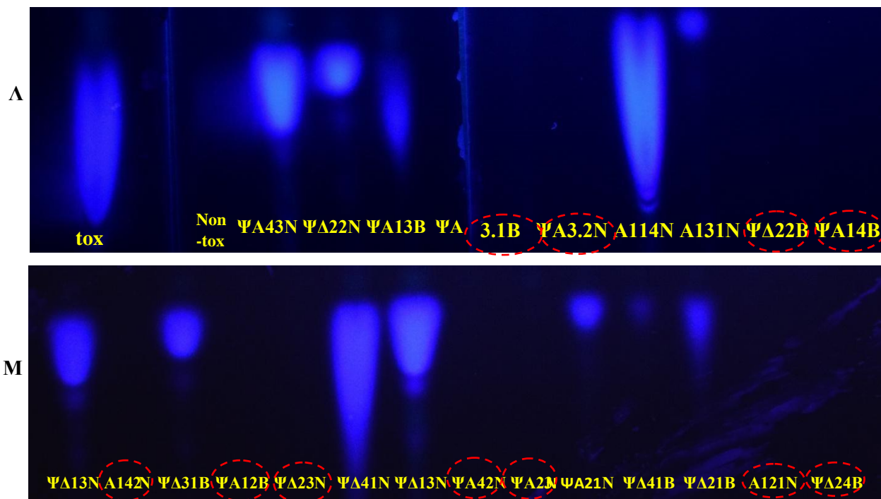
Εικόνα 4.12Α-4.12Μ: Αποτελέσματα δοκιμής σε πλάκες TLC για τη διερεύνηση της αποτελεσματικότητας των 161 βακτηριακών απομονώσεων ως προς την παρεμπόδιση στην παραγωγή αφλατοξινών σε υγρή συγκαλλιέργεια. Ως tox παρουσιάζεται ο θετικός μάρτυρας που είναι το τοξικογόνο στέλεχος του μύκητα, χωρίς βακτηριακό στέλεχος και ως not-tox ο αρνητικός μάρτυρας που είναι το μη τοξικογόνο στέλεχος του μύκητα. Οι υπόλοιπες θέσεις αφορούν σε μεικτές μολύνσεις τοξικογόνου μύκητα και απομονώσεων βακτηρίου. Με κόκκινο δακτύλιο περιβάλλονται τα ονόματα των αποτελεσματικών βακτηριακών απομονώσεων που μειώνουν την παραγωγή αφλατοξινών.
