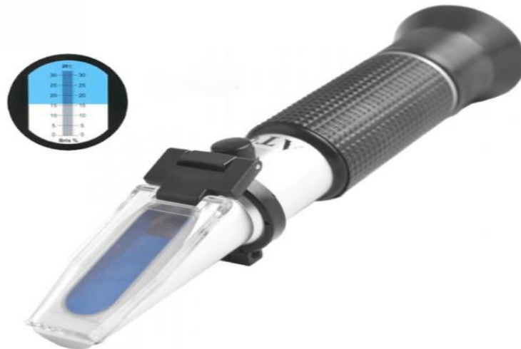
Εικόνα 15. Διαλαθασίμετρο σακχάρων (°Brix)
