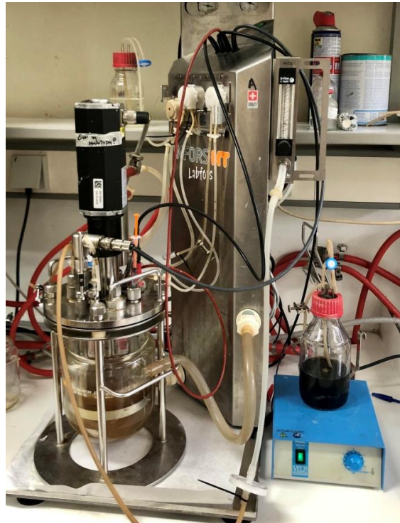
Εικόνα 6: Ημι-συνεχής ζύμωση σε βιοαντιδραστήρα όγκου 2 L (Labfors 4, Infors HT, Switzerland)
