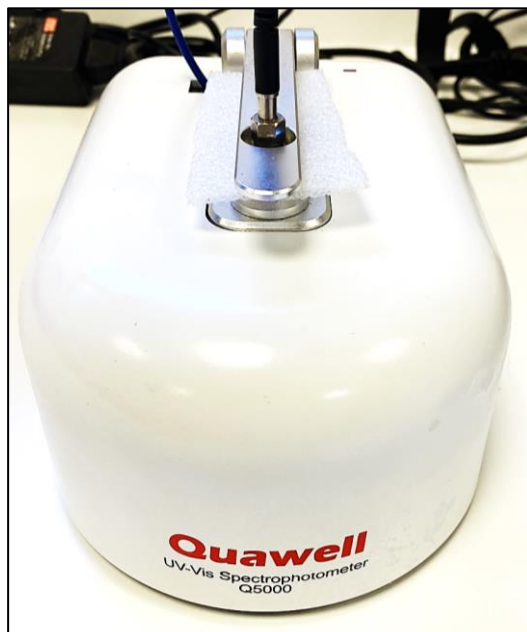
Εικόνα 3.7.1.1.: Το φασματοφωτόμετρο μικροποσοτήτων (Quawell Q5000 Read First UV-Vis Spectrophotometer, Quawell Technology Inc., San Jose, USA)
