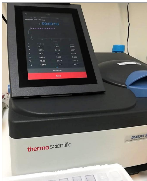
Εικόνα 4.4.1.: Το φασματοφωτόμετρο GENESYS 180 UV-Vis Spectrophotometer που χρησιμοποιήθηκε για την ανάλυση του αντιοξειδωτικού συστήματος του γάλακτος
