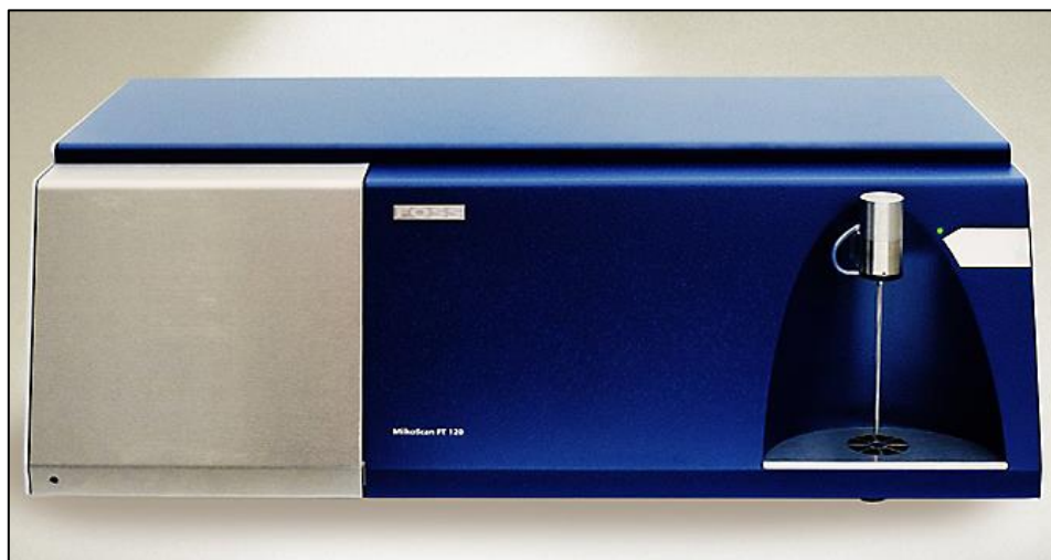
Εικόνα 3.2.1.: Η συσκευή Milkoscan Foss FT120
