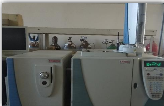
Εικόνα 12. Ανάλυση των πτητικών συστατικών σε αέριο χρωματογράφο-φασματογράφο μάζας..
