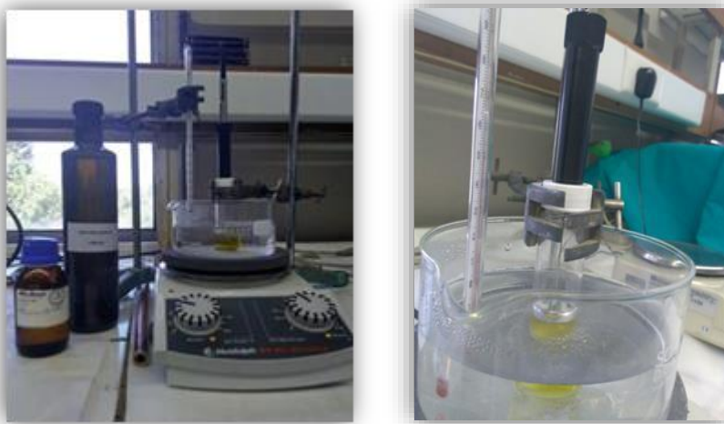
Εικόνα 11. Εκχύλιση των πτητικών συστατικών με μικροεκχύλιση στερεάς φάσης SPME.
