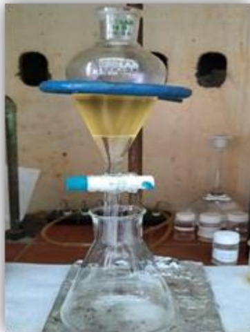
Εικόνα 15. Διαχωριστική χοάνη με τις δύο φάσεις που έχουν σχηματιστεί από τις εκχυλίσεις με υδατική μεθανόλη (η πάνω είναι η φάση με το εξάνιο και η κάτω η μεθανολική φάση με τα φαινολικά)
