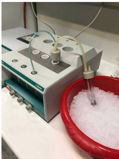
Εικόνα 12: Συσκευή Rancimat όπως τροποποιήθηκε για την παραγωγή \alpha -δικαρβονυλικών ενώσεων και την παραγωγοποίησή τους σε κινολίνες κατά τη θέρμανση ελαιολάδων (αριστερά) και σχηματική αναπαράσταση της συνδεσμολογίας της (δεξιά).
