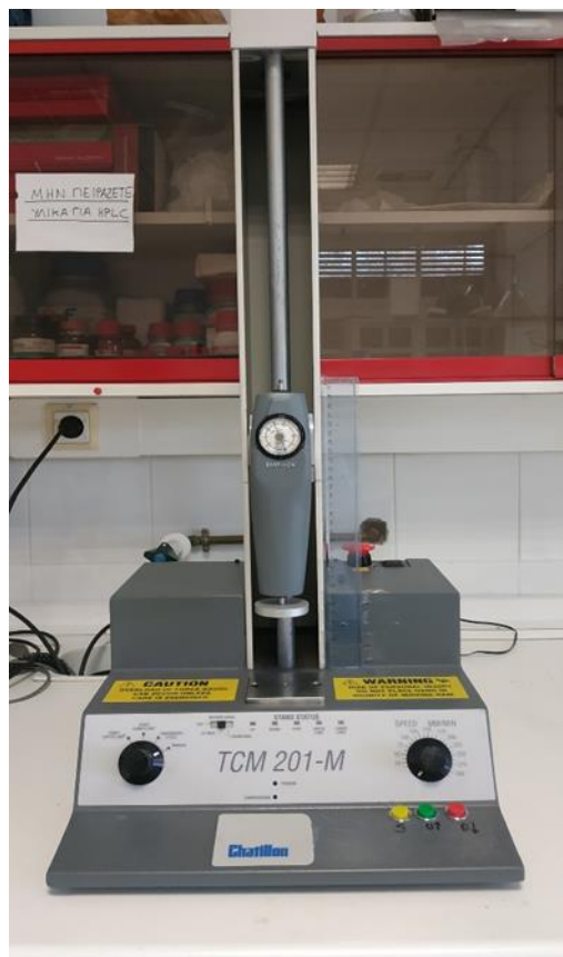
Εικόνα 2.6 Ο αναλυτής υφής (Chatillon DFIS-10 τοποθετημένος στη βάση TCM 201-M) που χρησιμοποιήθηκε για τον προσδιορισμό της συνεκτικότητας των καρπών.
