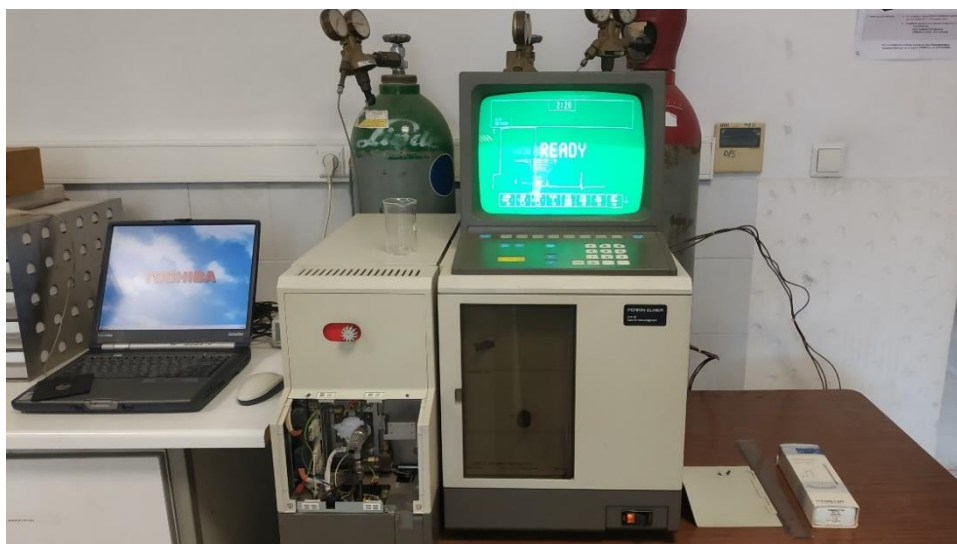
Εικόνα 2.4 Ο αέριος χρωματογράφος (PERKIN – ELMER 8310B Gas Chromatography) που χρησιμοποιήθηκε για τον προσδιορισμό του ρυθμού παραγωγής αιθυλενίου από τους καρπούς τομάτας.
