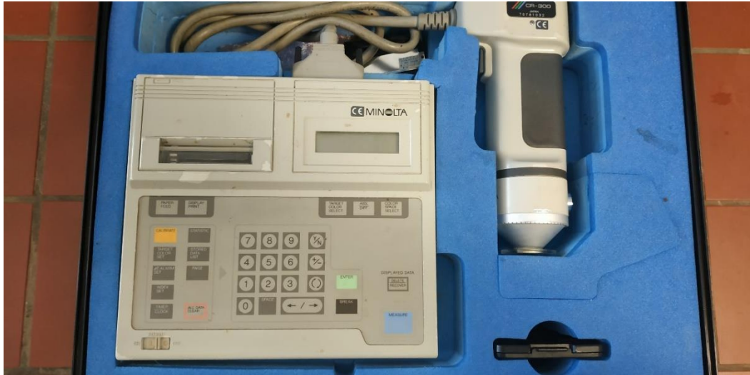
Εικόνα 2.3 Το χρωματόμετρο (Minolta CR-300) που χρησιμοποιήθηκε για τον προσδιορισμό του χρώματος των καρπών.
