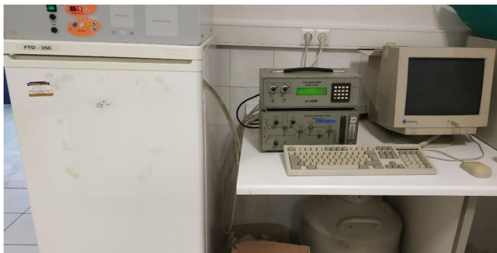
Εικόνα 2.5 Ο αναλυτής διοξειδίου του άνθρακα που χρησιμοποιήθηκε για τον προσδιορισμό της αναπνευστικής δραστηριότητας των καρπών τομάτας.
