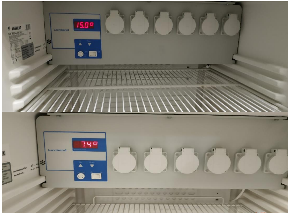
Εικόνα 2.2 Οι θάλαμοι που χρησιμοποιήθηκαν για την διεξαγωγή του πειράματος συντήρησης ώριμων κόκκινων καρπών στους 7 °C (κάτω) και στους 15 °C (πάνω)
