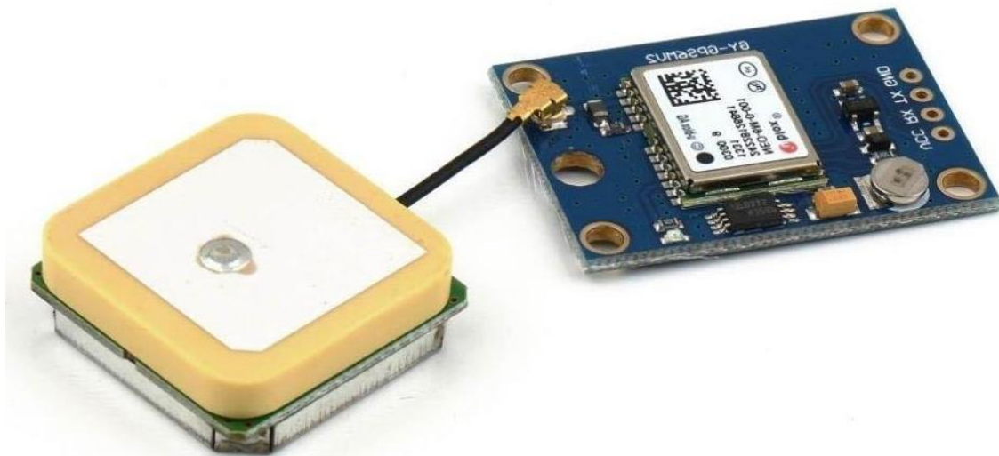
Εικόνα 18. Ένας απλός δέκτης GPS, που χρησιμοποιήθηκε στο σύστημα
