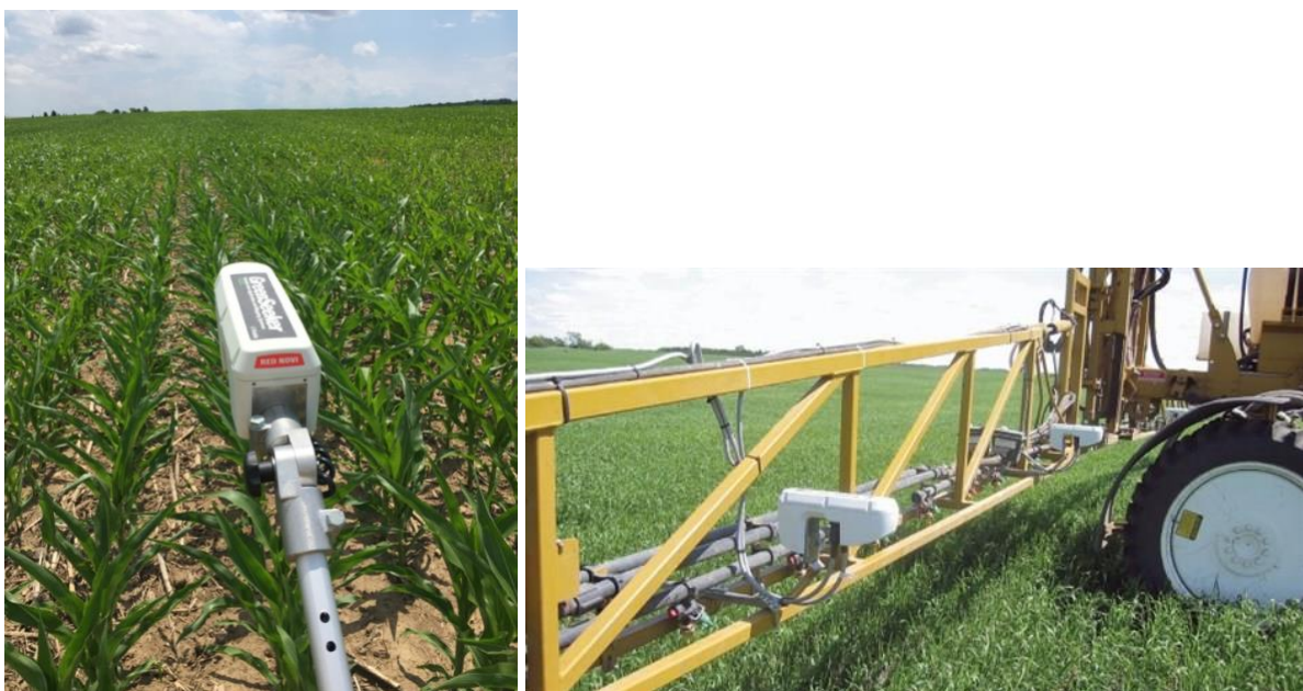
Εικόνα 2 Αισθητήρας που χρησιμοποιεί το Greenseeker (αριστερά) και ενσωμάτωσή του σε εφαρμογέα μεταβλητής ροής (δεξιά)
