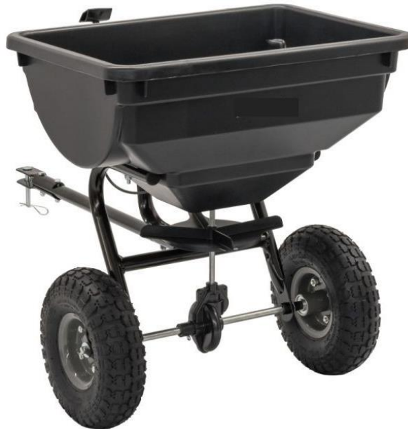
Εικόνα 19. Λιπασματοδιανομέας περιστρεφόμενου δίσκου, ιδανικός για κοκκώδες λίπασμα
