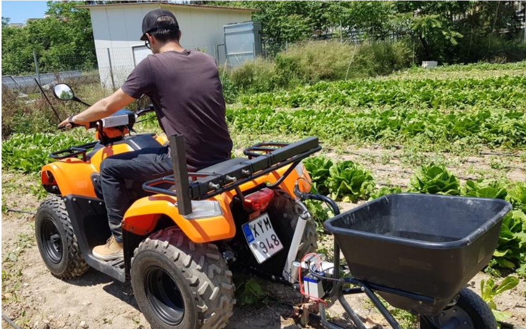
Εικόνα 31. Ο λιπασματοδιανομέας μαζί με το υπόλοιπο υλικό προσαρτημένο στην γουρούνα μέσα στον αγρό με τα μαρούλια
