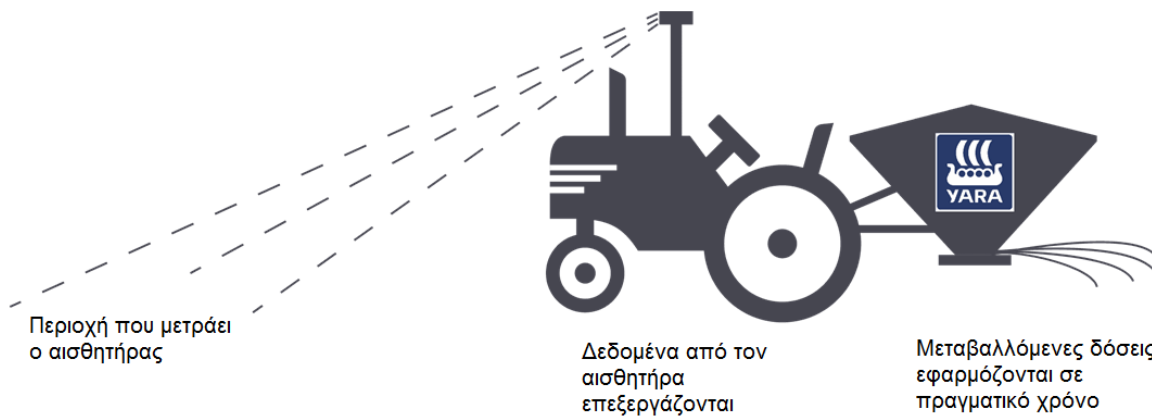
Εικόνα 3. Αισθητήρας που χρησιμοποιεί το Yara N-sensor (πάνω) και τρόπος λειτουργίας του (κάτω)
