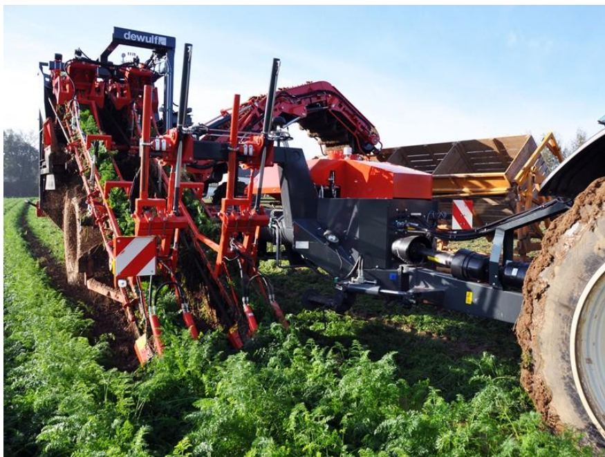
Εικόνα 1.3. Μηχανικός θεριστής πολλαπλών στροφών, που κόβει και τραβάει τα καρότα από τις κορυφές τους, χρησιμοποιώντας ένα σύστημα ζωνών [ https://www.dewulfgroup.com/en/product/harvesting/top-lifting-harvesters/trailed/gkiis ]
