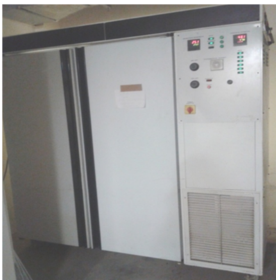
Εικόνα 15. Θάλαμος σταθερών συνθηκών. Εργαστήριο Γεωργικής Ζωολογίας και Εντομολογίας Γ.Π.Α.
