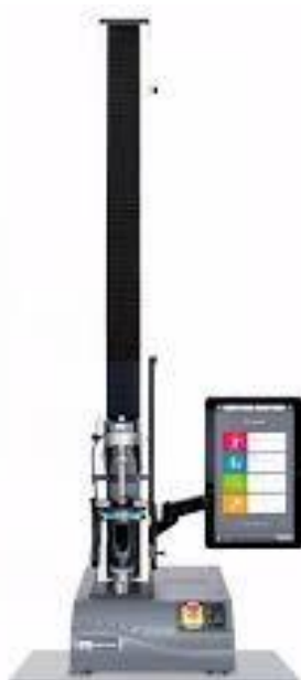
Εικόνα 15: Το μηχάνημα διάτρησης (Instron model 3343) που χρησιμοποιήθηκε στις εργαστηριακές έρευνες
