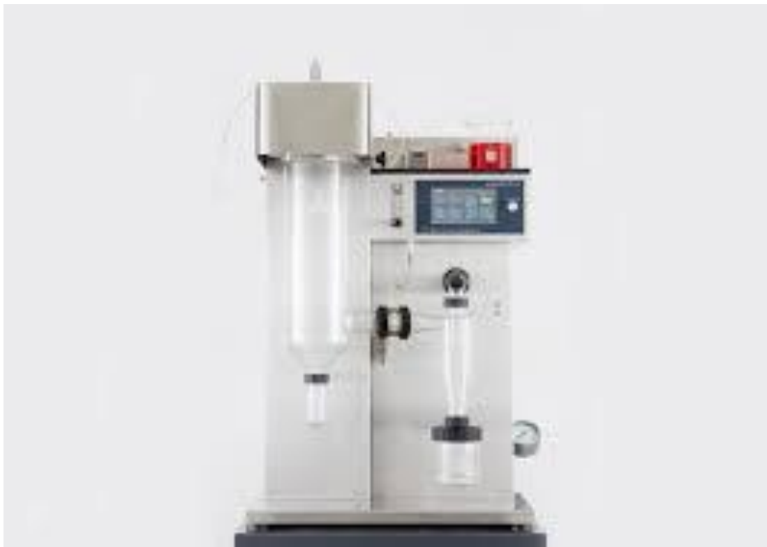
Εικόνα 9: Μηχάνημα ξήρανσης ψεκασμού, παρόμοιο με αυτό που χρησιμοποιήθηκε στις εργαστηριακές δοκιμές
