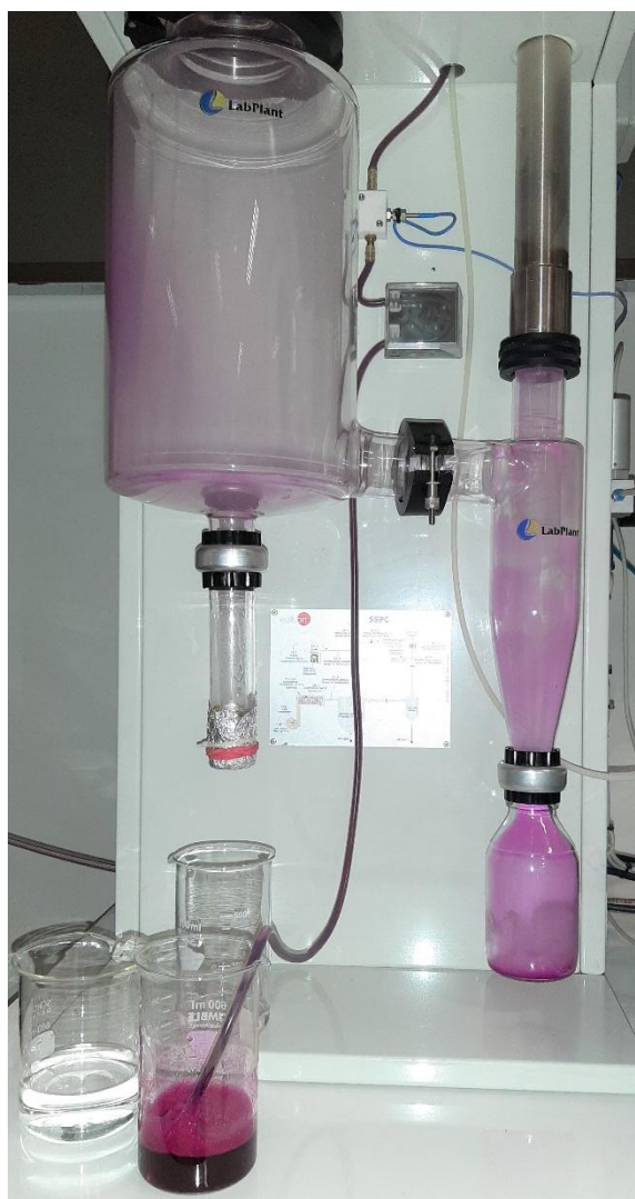
Εικόνα 13: Το μηχάνημα ξήρανσης ψεκασμού (spray-dryer) που χρησιμοποιήθηκε στην εργαστηριακή έρευνα EEdibon
