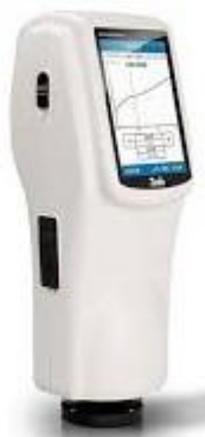
Εικόνα 14: Το μηχάνημα χρωματομέτρησης (High-Quality Spectrophotometer NS800S) που χρησιμοποιήθηκε στις εργαστηριακές μετρήσεις
