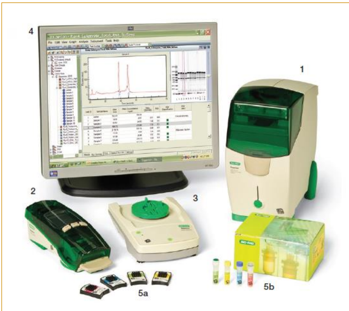
Εικόνα 3.5.6. Το σύστημα Experion. 1) αυτόματος σταθμός ηλεκτροφόρησης, 2) σταθμός εναύσματος, 3) σταθμός ανάδευσης (νοτεχ), 4) λειτουργικό σύστημα και εργαλεία ανάλυσης δεδομένων (λογισμικό), και 5) εργαλεία ανάλυσης τα οποία περιλαμβάνουν (a) τσιπ και (b) αντιδραστήρια αναλύσεων DNA
