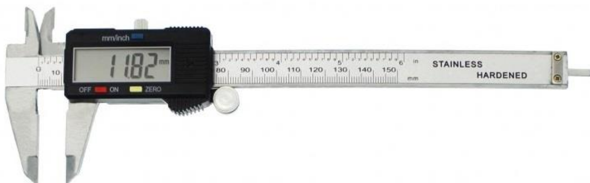
Εικόνα 2.1.6: Ηλεκτρονικό παχύμετρο ακριβείας. (φωτογραφία, google photos)
