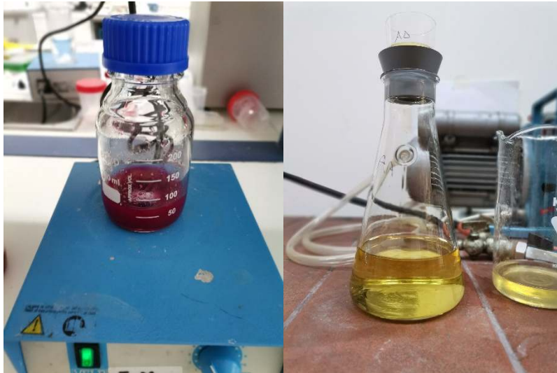
Εικόνα 2: Ανάδευση σκόνης συμπυκνωμένου κλάσματος με ρυθμιστικό διάλυμα (αριστερά) και διήθηση υπό κενό (δεξιά) για τον προσδιορισμό των αδιάλυτων διαιτητικών ινών.
