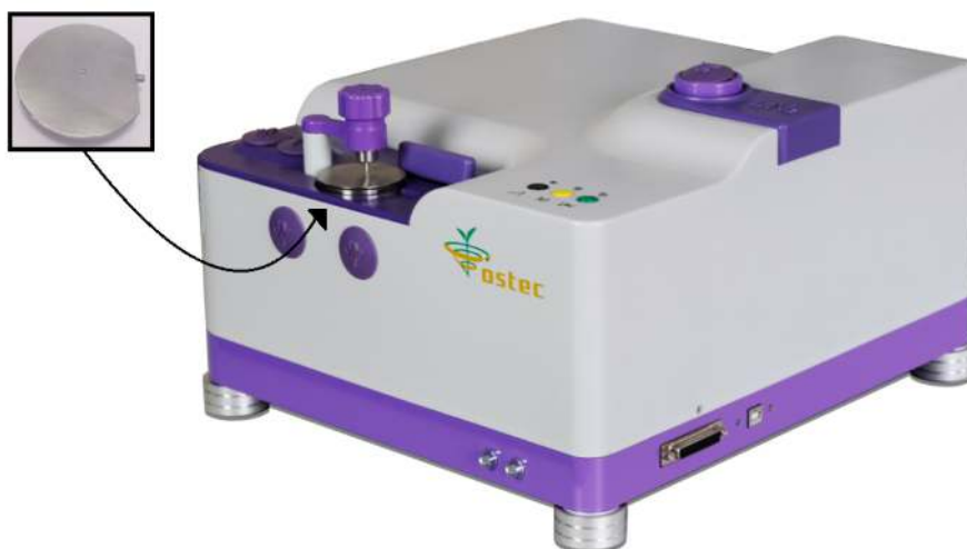
Εικόνα 42. Το φασματοφωτόμετρο FT-IR Ostec IROS 05 που χρησιμοποιήθηκε και ο υποδοχέας του δείγματος.
