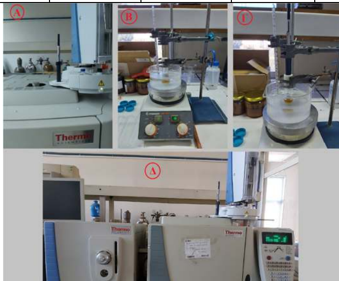
Εικόνα 13. Πειραματική διαδικασία SPME - GC/MS.
