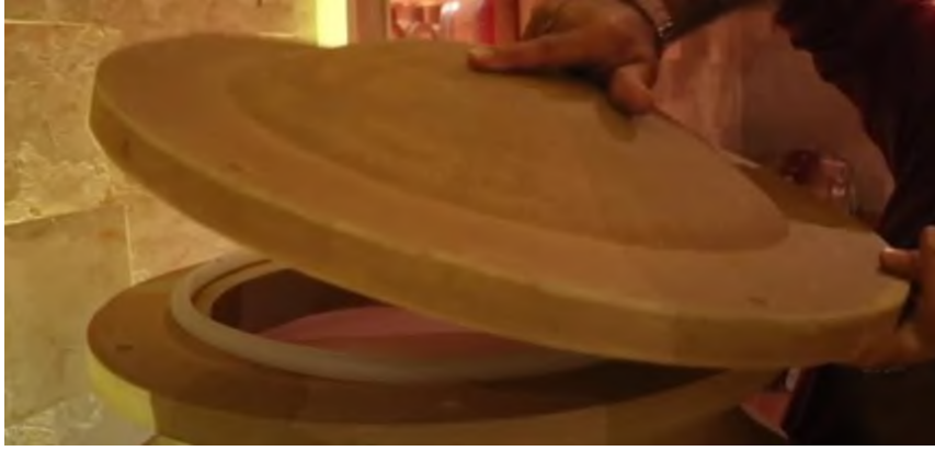
Εικόνα 2.11. Κλείσιμο αμφορέα με πήλινο καπάκι και τοποθέτηση στεφανιού σιλικόνης για ερμητικό σφράγισμα
