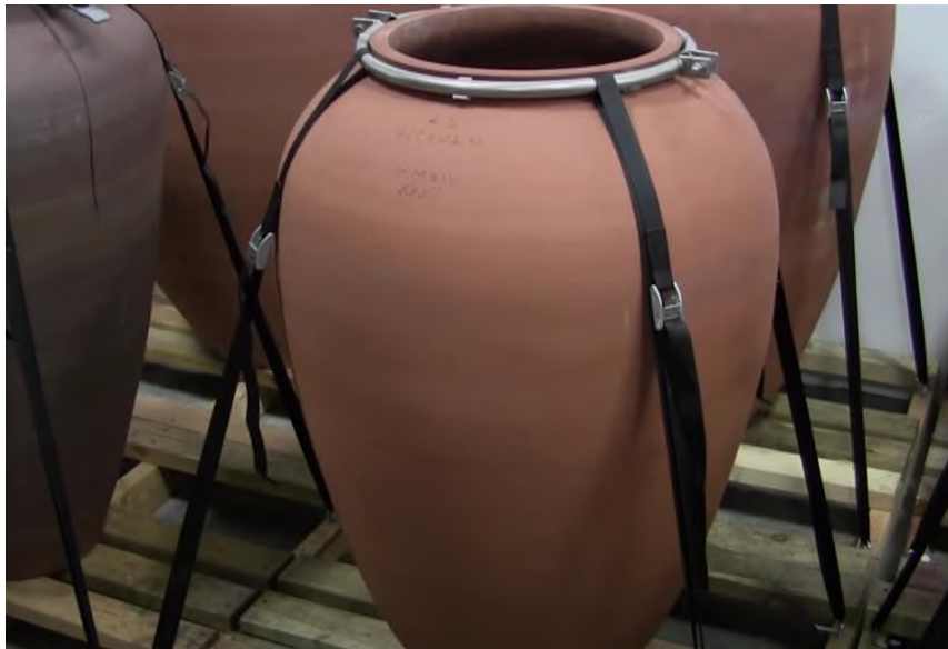
Εικόνα 2.14. Τοποθέτηση αμφορέα σε ξύλινη παλέτα και σταθεροποίηση με μάντες μέσω ανοξείδωτης στεφάνης
