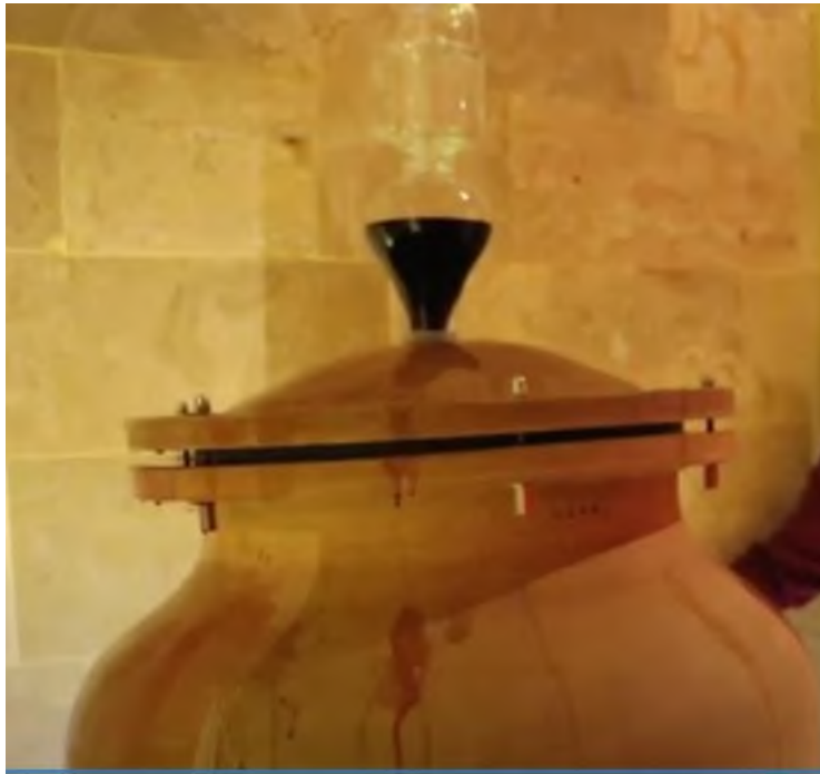
Εικόνα 2.12. Πήλινο καπάκι αμφορέα, κλείσιμο και σταθεροποίηση με βίδες.
