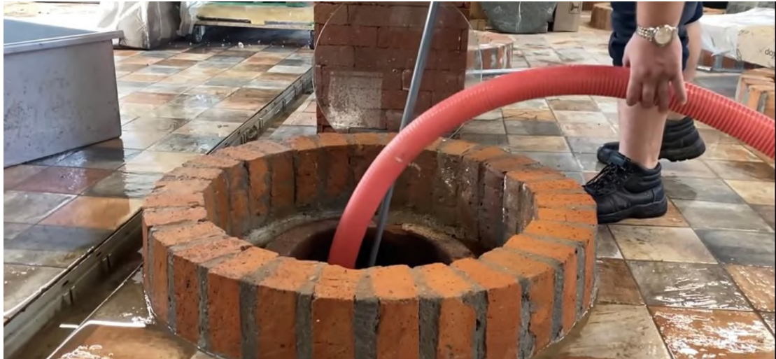
Εικόνα 2.15. Αναρρόφηση και μεταφορά οίνου και στεμφύλων με αντλία
