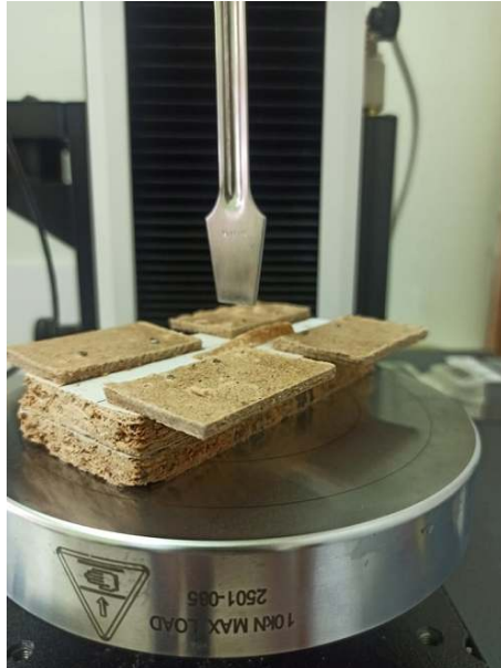
Εικόνα 7: Διαδικασία και οργανολογία κοπής ζυμαρικών
