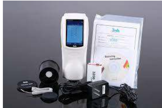
Εικόνα 8: Το σπεκτροφωτόμετρο που χρησιμοποιήθηκε για τη λήψη μετρήσεων χρώματος
