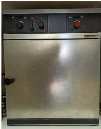
Εικόνα 5: Φούρνος Memmert BE 400, ο οποίος χρησιμοποιήθηκε κατά την πειραματική διαδικασία για ξήρανση
