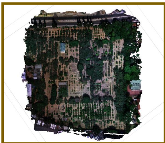
Εικόνα 50 : Το πυκνό νέφος σημείων (dense point cloud) σύμφωνα με το οποίο κατασκευάζεται έπειτα το 3D μοντέλο (Φωτογραφία του προγράμματος Metashape από Αραποστάθη Ευαγγελία)
