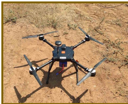
Εικόνα 43 : Το ΣμηΕΑ Mera που χρησιμοποιήθηκε στην πτήση για την συλλογή δεδομένων (Φωτογραφία από Κάρελλα Κωνσταντίνο)
