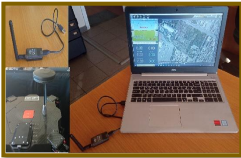
Εικόνα 45 : Πάνω αριστερά, το καλώδιο τηλεμετρίας που χρησιμοποιείται στην «επικοινωνία» υπολογιστή – ΣμηΕΑ. Κάτω αριστερά, ο πιλότος του ΣμηΕΑ που δέχεται και στέλνει δεδομένα στον υπολογιστή. Δεξιά, ο υπολογιστής συνδεδεμένος με το καλώδιο τηλεμετρίας (Φωτογραφία από Αραποστάθη Ευαγγελία)
